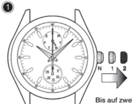
1. Ziehen Sie die Krone bis auf die zweite Position heraus, wenn der Sekundenzeiger sich auf der 12 befindet.
